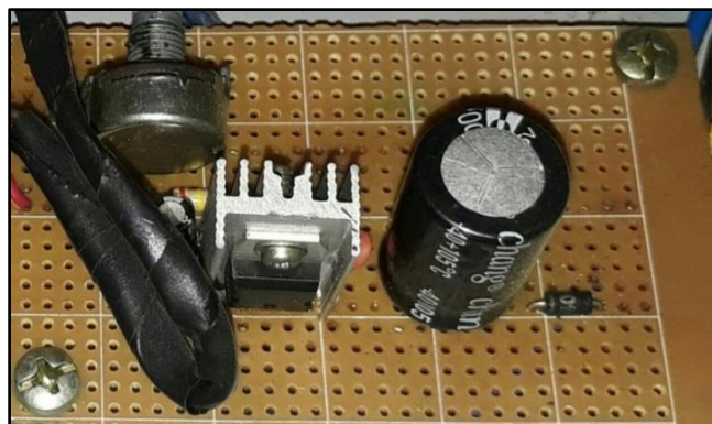
Procedimiento al desarrollo Regulador de voltaje LM 317
