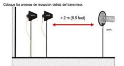
*Distancia entre antenas de recepción y antenas de transmisión*
