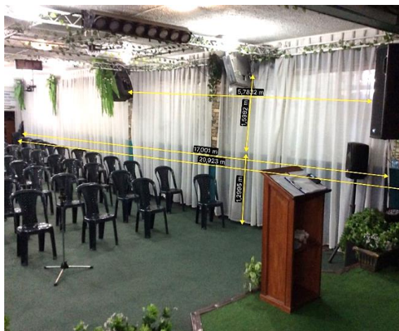
Ilustración 29. Medición del recinto con el telemetro GLM100C Fuente: Elaboración Propia
