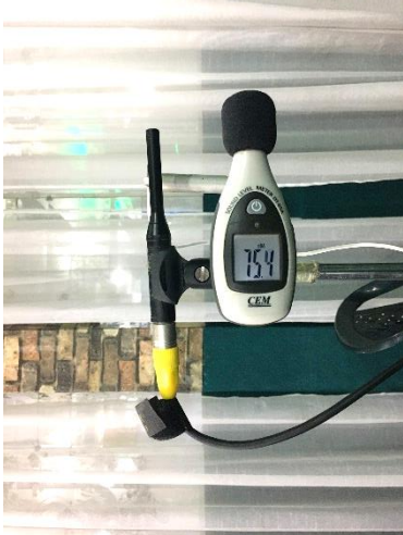
Ilustración 34. Mediciones del NPS en el punto B1 Fuente: Elaboración Propia
