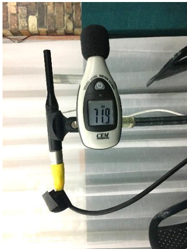
Ilustración 38. Mediciones del NPS en el punto C1 Fuente: Elaboración Propia
