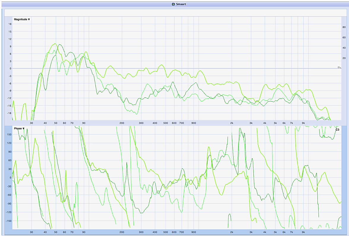
Ilustración 37. Magnitud y Fase, Mediciones del espectro en los puntos C1, C2, C3. Fuente: Elaboración propia
