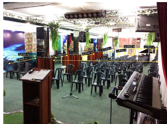
Ilustración 28. Medición del recinto con el telemetro GLM100C Fuente: Elaboración Propia
