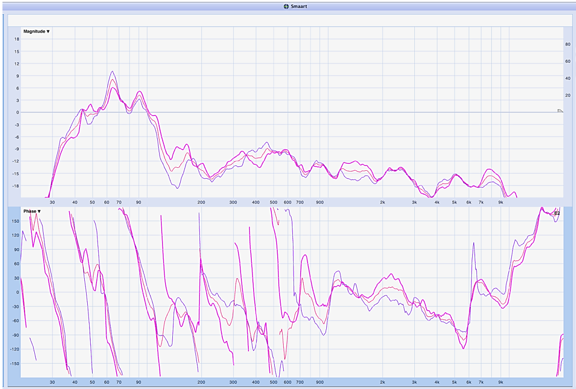
Ilustración 45. Magnitud y Fase, Mediciones del espectro en los puntos E1, E2, E3. Fuente: Elaboración propia
