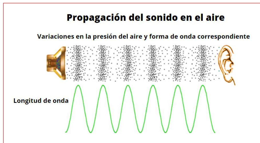
Ilustración 1. Propagación del sonido en el aire Fuente: Zapata, F. (2018). Propagación del sonido: velocidad, medios, experimentos
