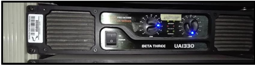
Figura 20. Amplificador de potencia UA1330 del canal surround Rs. (Elaboración propia).
