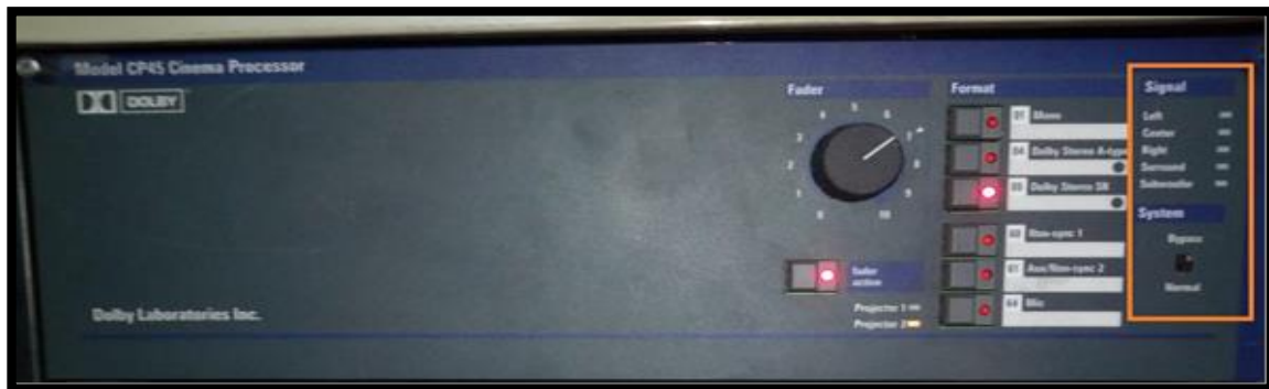
Figura 26. Muestra los Indicadores Led y la función de ByPass del procesador Dolby CP45. (Elaboración propia).
