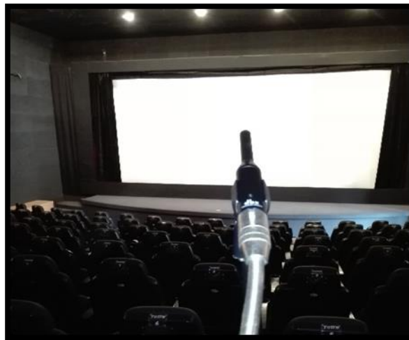
Figura 46. Micrófono Posicionado a 45^\circ en dirección de la pantalla. (Elaboración Propia).
