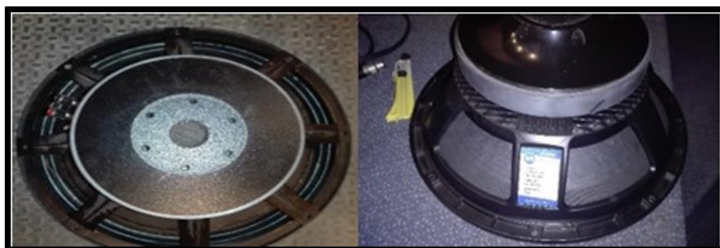
Figura 18. Reemplazo de los altavoces de 15'' dañados. (Elaboración propia).
