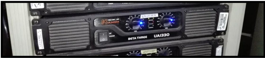
Figura 19. Amplificador de potencia del canal surround Ls. (Elaboración Propia).
