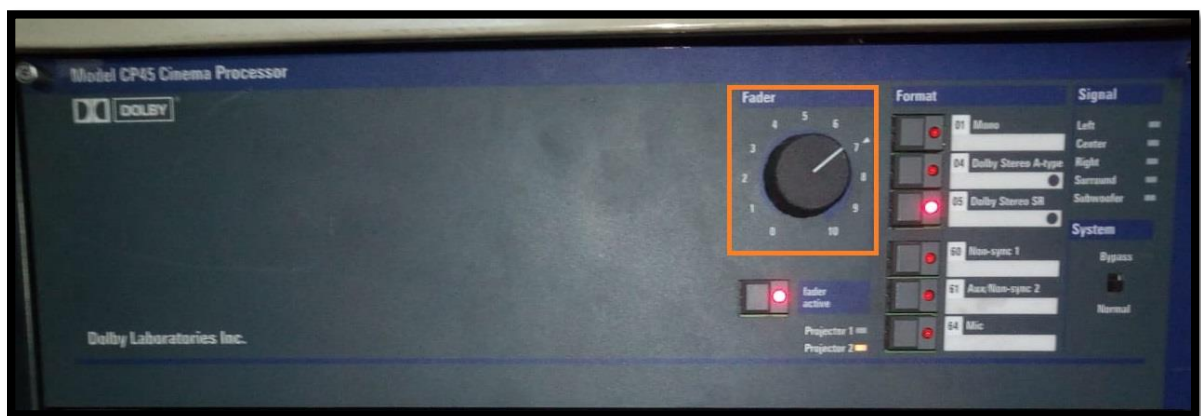
Figura 24. Muestra el potenciómetro “Fader” principal del procesador Dolby CP45 . (Elaboración propia).
