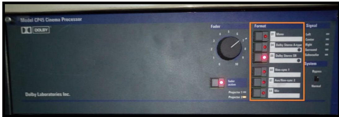
Figura 25. Muestra el “Formato” del panel frontal del procesador Dolby CP45. (Elaboración propia).
