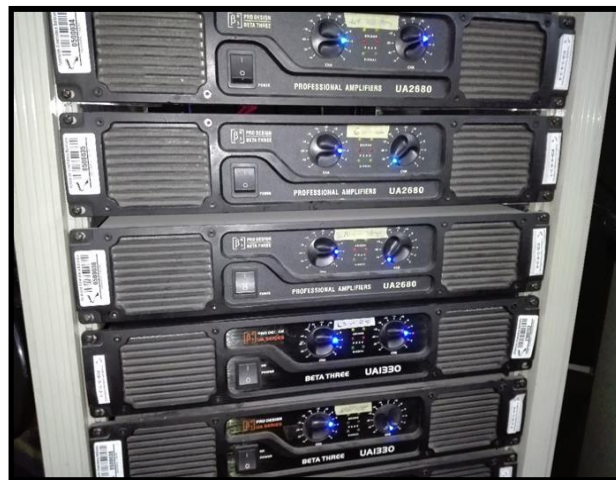
Figura 44. Amplificadores de Potencia UA2680 y UA1330. (Elaboración propia).
