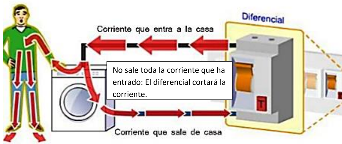
Figura 13. Fuga de corriente
