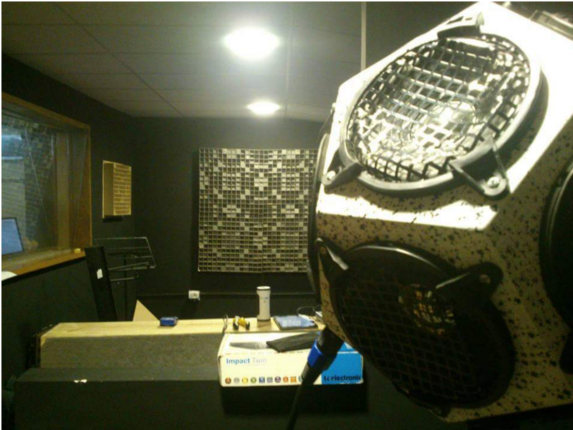
Figura 22. Momento de la medición realizada con el uso de la Fuente Sonora Omnidireccional, en la sala de grabación de la Carrera de Ing. Sonido de la UNITEPC
