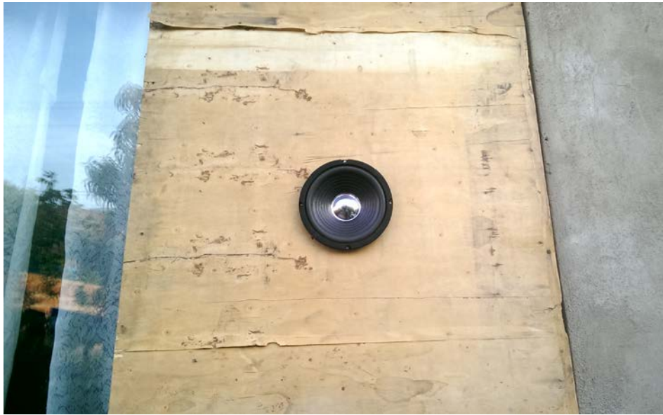
Figura 24. Se muestra el altavoz de marca BlastKing (utilizado en la F.S.O.) montado sobre una pared o pantalla infinita, para hallar la frecuencia de resonancia del altavoz
