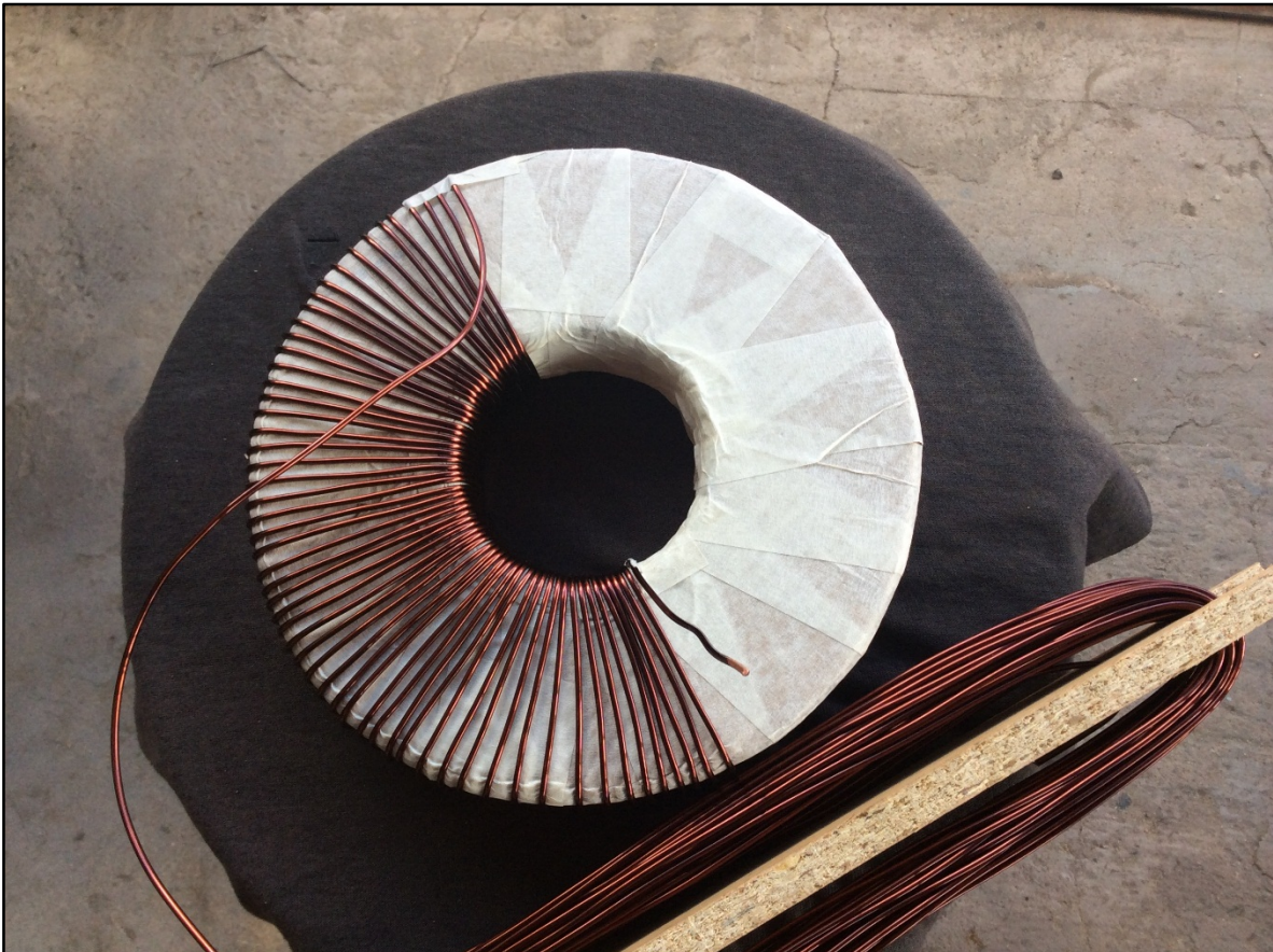
Figura 4. Donde se puede observar el comienzo del devanado primario del transformador toroidal.
