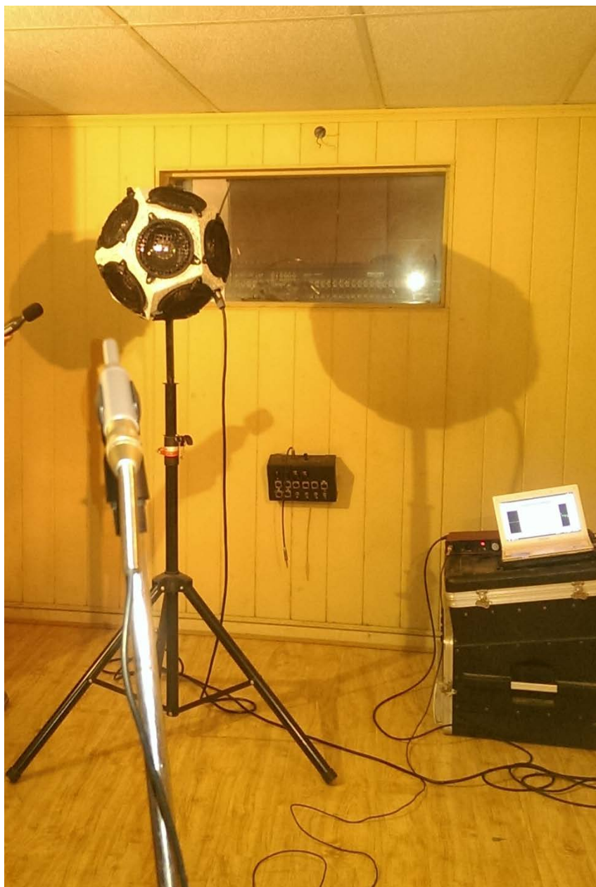
Figura 20. Medición realizada con una F.S.O en el mismo recinto
