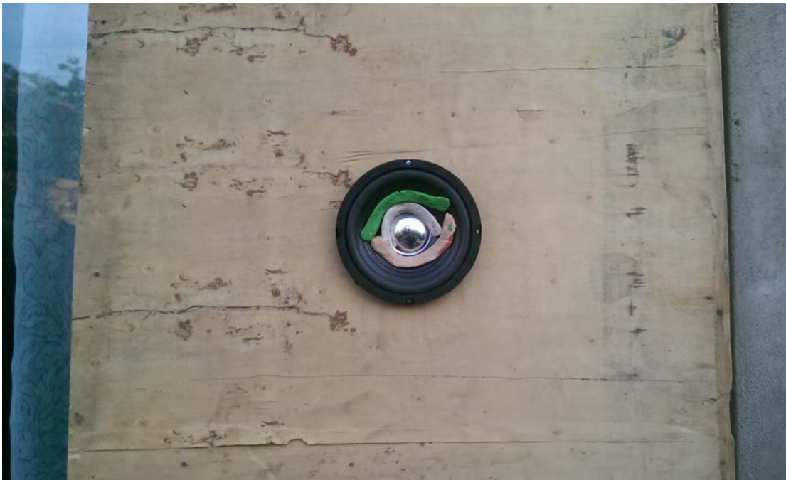
Figura 25. Se muestra el altavoz de marca BlastKing (utilizado en la F.S.O.) montado sobre una pared o pantalla infinita, utilizando el método de la masa añadida (en este caso haciendo uso de masa plastilina) para estimar los parámetros Thiele-Small.
