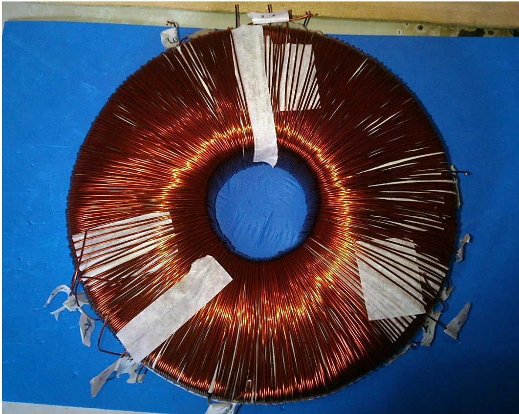
Figura 6. La imagen nos muestra el transformador terminado con todos los devanados correspondientes
