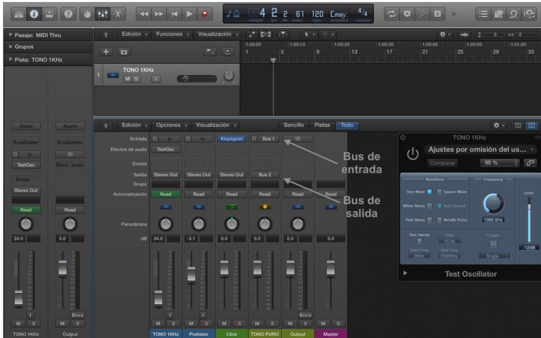
FIGURA 23 LOGIC PRO X ASIGNACIÓN DE BUS DE ENTRADA Y SALIDA EN EL CANAL AUXILIAR
