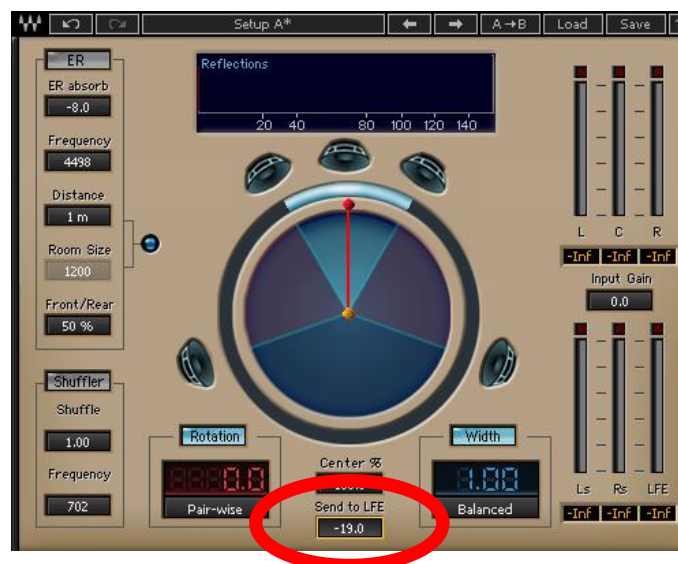
Fig. 36 Detalle del control de envío al canal LFE
