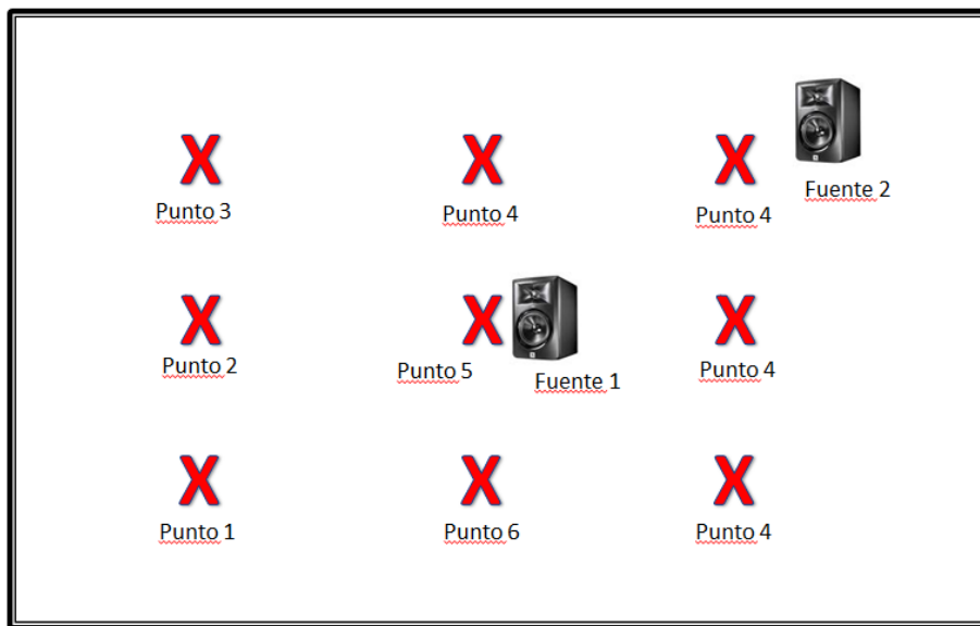
Fig. 30 Disposición de las Fuentes y del Micrófono de medición
