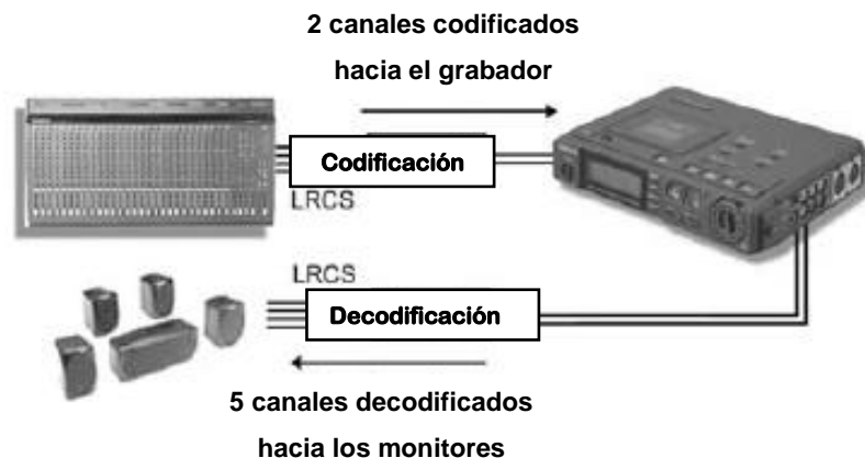
Fig. 24 Esquema de codificación y decodificación de Dolby Pro Logic
