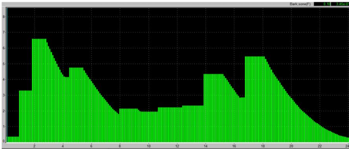
Gráfico 5.14. Diagrama (Paisaje Sonoro.2.) del contenido energético espectral de las 24 Bandas Críticas.
