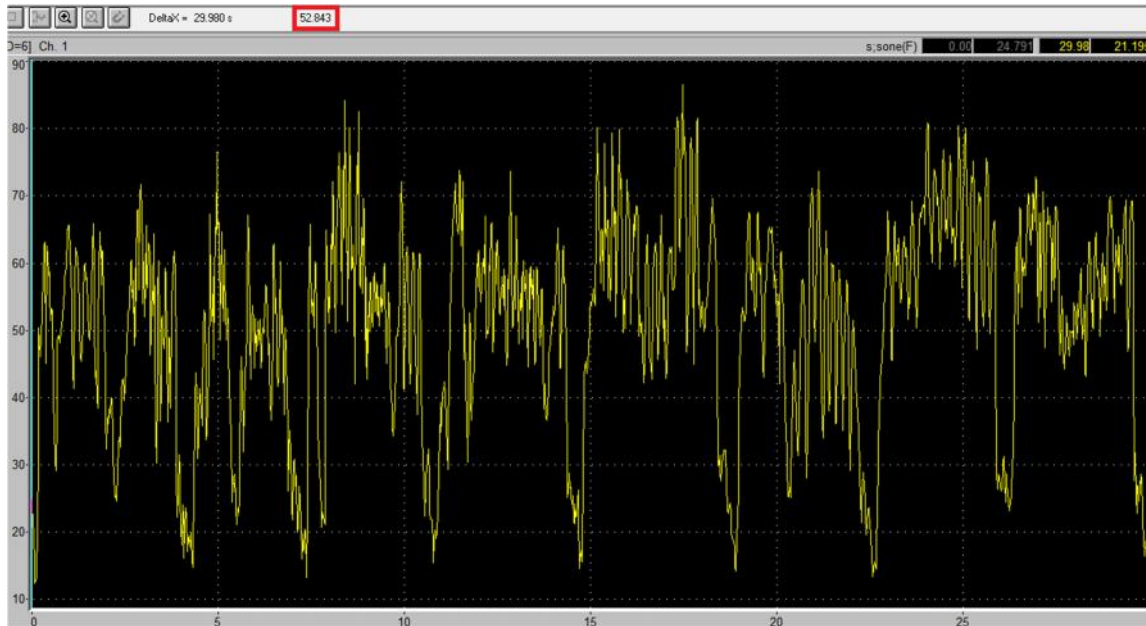
Gráfico 5.1. Diagrama de análisis para la determinación del Nivel Continuo Equivalente Leq. (Flauta Andina)
