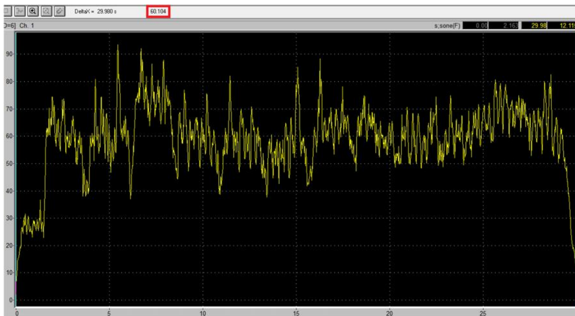
Gráfico 5.4. Diagrama de análisis para la determinación del Nivel Continuo Equivalente Leq . (Sinfonía Mozart).
